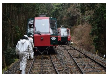
車両後部に新しいロープを接続し、離合箇所まで運転
